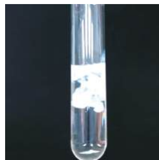
Fig. 4. Precipitarea sulfatului de bariu
