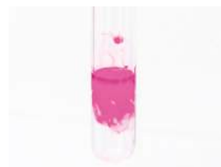
Fig. 7. Reacția oxidului de magneziu cu apa în prezența fenolftaleinei
