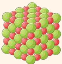
Fig. 1. Clorura de sodiu este formată din ioni de sodiu (●) și ioni de clor (●)
