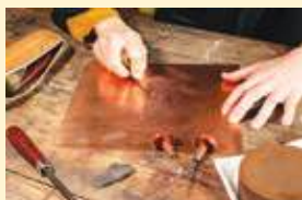
Fig. 2. Gravarea cu ajutorul burinului pe placa de cupru
