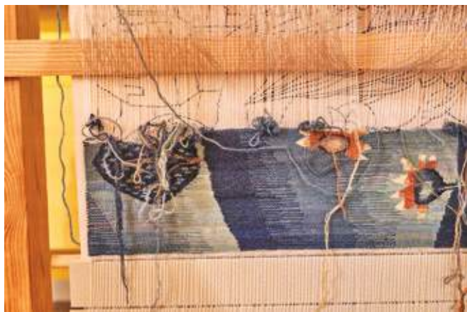
Fig. 6. – Tapiserie pe război înalt ( haute-lisse ) cu carton în spatele țesăturii
